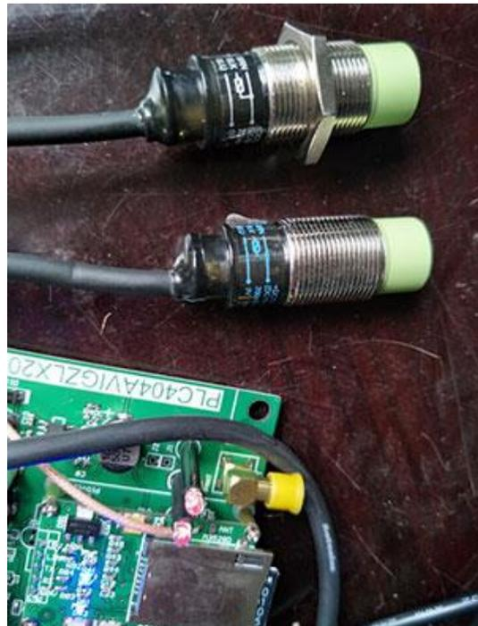
电脑端软件，设备输入端，IO 口加入电压从 12V-48V 输入对地电压，就可以采集到 数字 1 的信号。就是模拟量信号，输入端的正，COM 口和 GND 对地，电压大于 0-5V，软件就可以直接采集到两路或三路的电压，电流模拟量。
