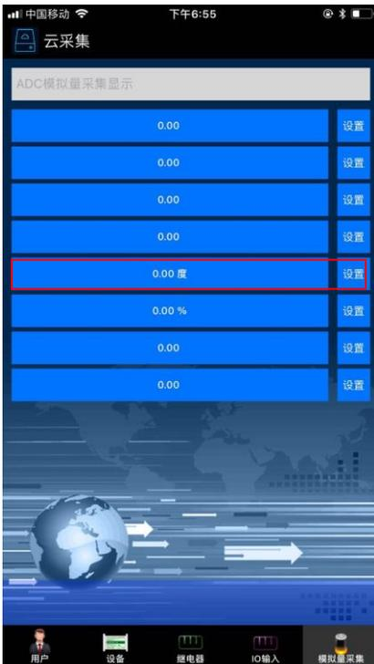
温度电流信号线是接到控制器的输入5,所以选择第五个,点击右边的设置。
