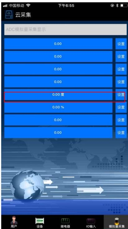
温度电流信号线是接到控制器的输入5,所以选择第五个,点击右边的设置。
