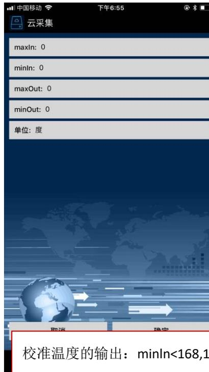
校准温度的输出:  $\text{minIn} < 168, 1023 < \text{maxIn}$
