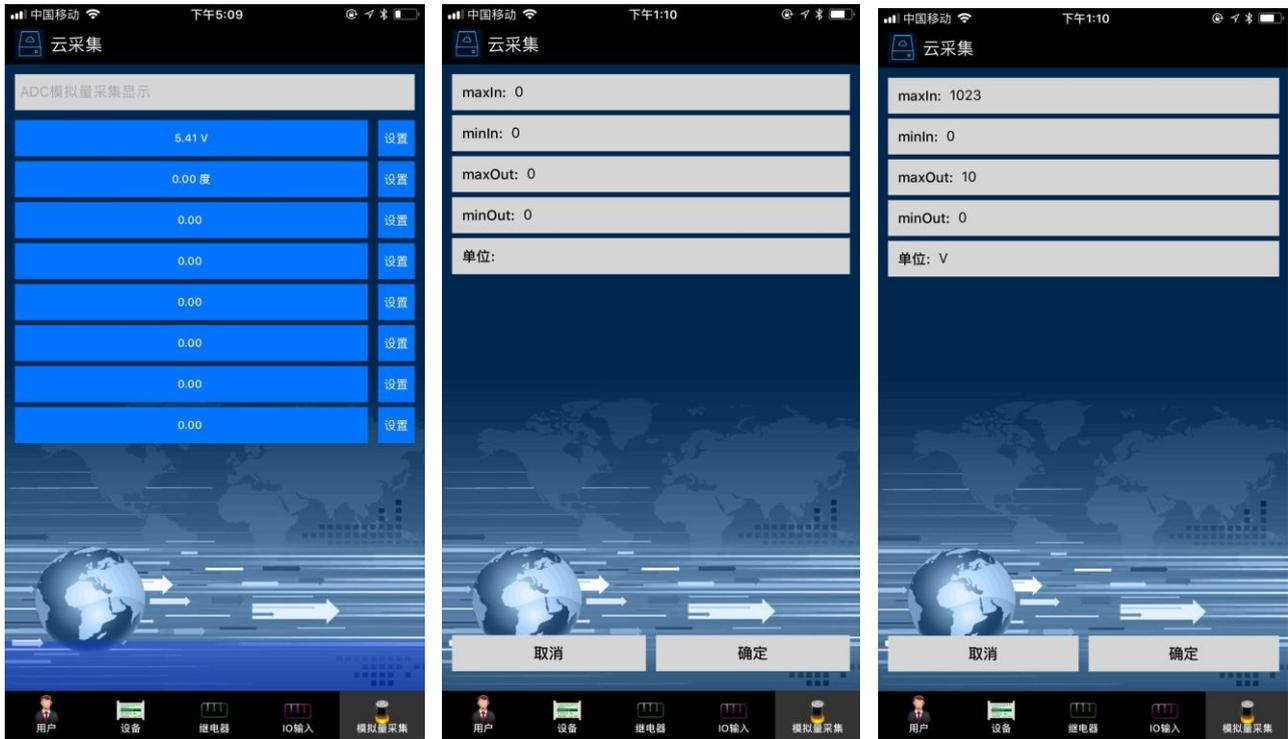
如果你购买的设备是带模拟量输入的：如上图：第一路接了一个 0-10V 的电压互感器，设置模拟量的参数如图，可以实时显示电压的数值
